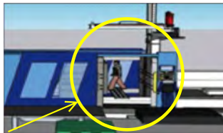
재해자가 사출성형기 내부에 대기한 상태
